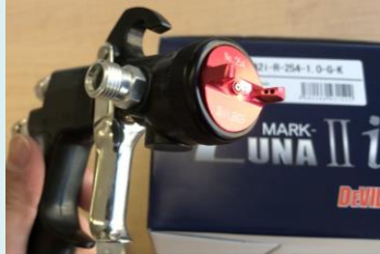
デビルビス LUNA2i-R-254-G-K 重力式・ノズルサイズ1.3
