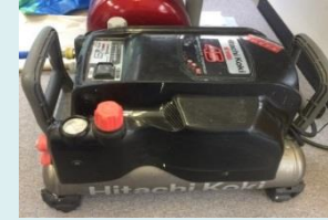
エアコンプレッサー 1馬力=0.75kw以上 最高圧力0.7Mpa以上のもの
